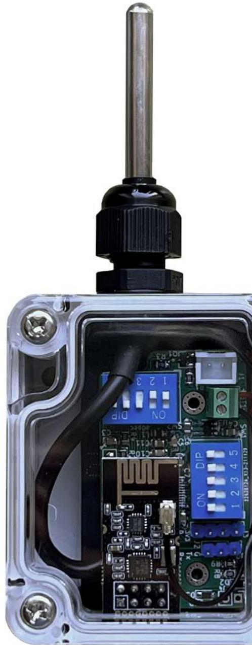
Система беспроводных датчиков состоит из одной базовой станции «мама - утка» и самих датчиков «утятка». Мама - утка ведет постоянный опрос вокруг себя и если в поле зрения есть утятка, то она их узнает и ведет с ними диалог. Одновременно мама - утка может поддерживать до 32 утят.
